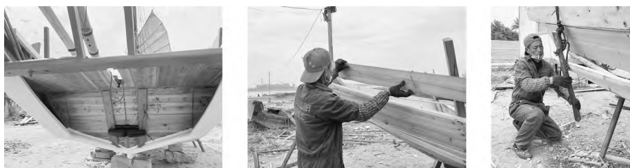
图 2 黄秀宝（阿阔）用传统工具依照传承技术制造传统抓蟹船（林江珠拍摄）
