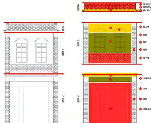
图2- 漳州骑楼的分段分析示意图 (图片来源:作者根据延安路181号立面绘制)
